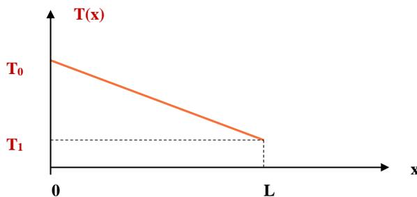
Le profil de température ne dépend pas de la conductivité thermique  $\lambda$  et donc de la nature du matériau. Cela vient du fait qu'on est en régime stationnaire et le paramètre temps n'intervient pas.
